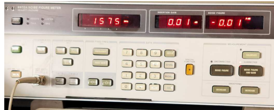
DUT Gain & NF at 1575MHz
